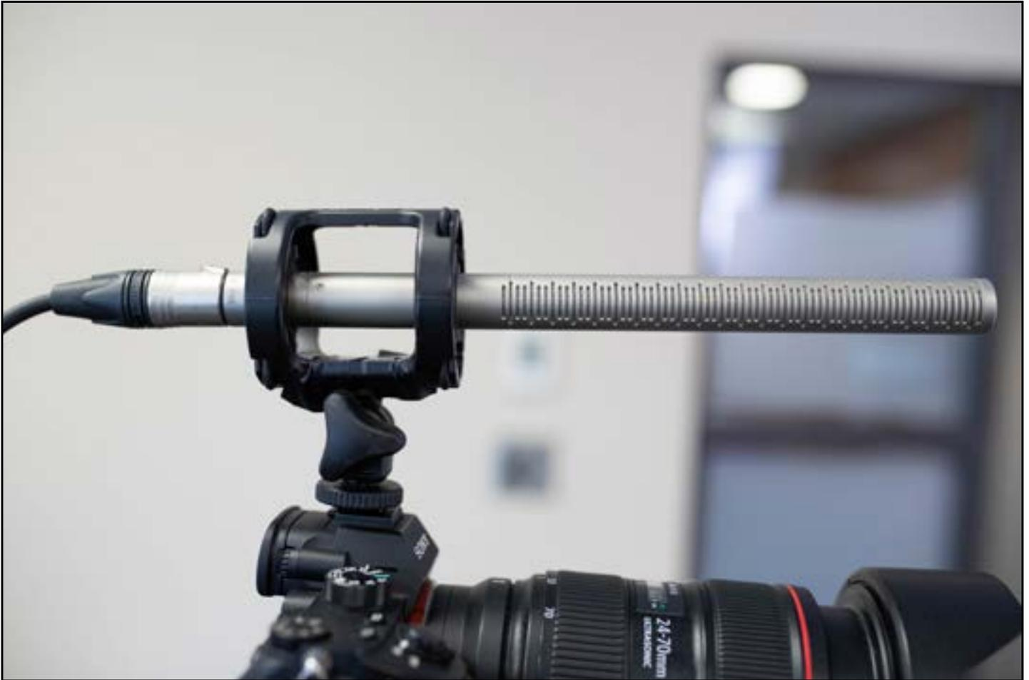
En ce qui concerne l'enregistrement du son, il est recommandé d'utiliser un système permettant de brancher le micro directement dans la caméra, et ce, via un port de type «jack 1/8». Selon le modèle de la caméra, il se pourrait qu'il n'y ait aucune prise pour brancher le micro. Il se pourrait aussi que la prise soit différente, par exemple qu'il s'agisse d'une prise «XLR» ou «mini-XLR».
